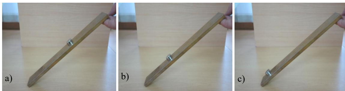
Rys. 2. Magnes neodymowy zsuwa się ruchem jednostajnym po miedzianej równi.
