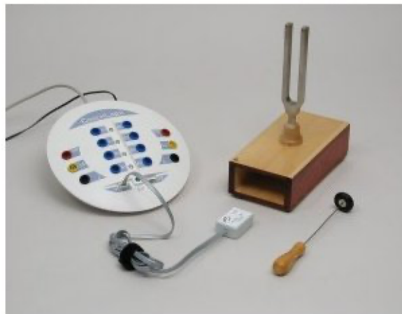
Rys. 1. Sposób podłączenia czujnika dźwięku do konsoli pomiarowej
