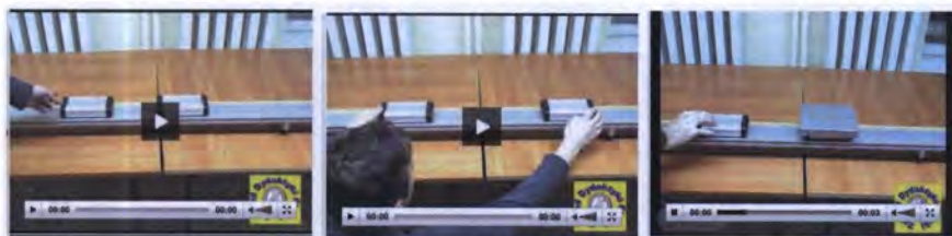
Ryc. 6. Sekwencja stopniowania trudności w ścieżce dydaktycznej: zderzenia wózków na torze Pasco: (a) poruszający się wózek uderza w wózek nieruchomy (ukryty przekaz dydaktyczny – przekaz pędu), (b) dwa wózki poruszające się z różnymi prędkościami zderzają się (wymiana pędu), (c) zderzenia wózków o różnych masach (przekaz dydaktyczny: pęd jest iloczynem prędkości i masy). Każda sekwencja trwa 3–4 sekundy i wprowadza nowe aspekty tego samego prawa (zachowania pędu) Koncepcja GK, realizacja KS i dr A. Karbowski [11]
