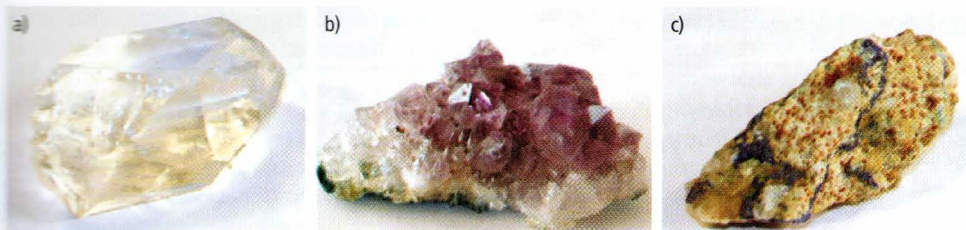
Fot. 10. Kvarc ( \text{SiO}_2 ) jest bezbarwny (a), a ten sam tlenek domieszkowany jonami żelaza staje się fioletowy (b – ametyst), azuryt \text{Cu}_3(\text{CO}_3)_2(\text{OH})_2 , małe wytrącenia na wapieniu, jest niebieski (c). Zbiory autora, fot. K. Służewski
