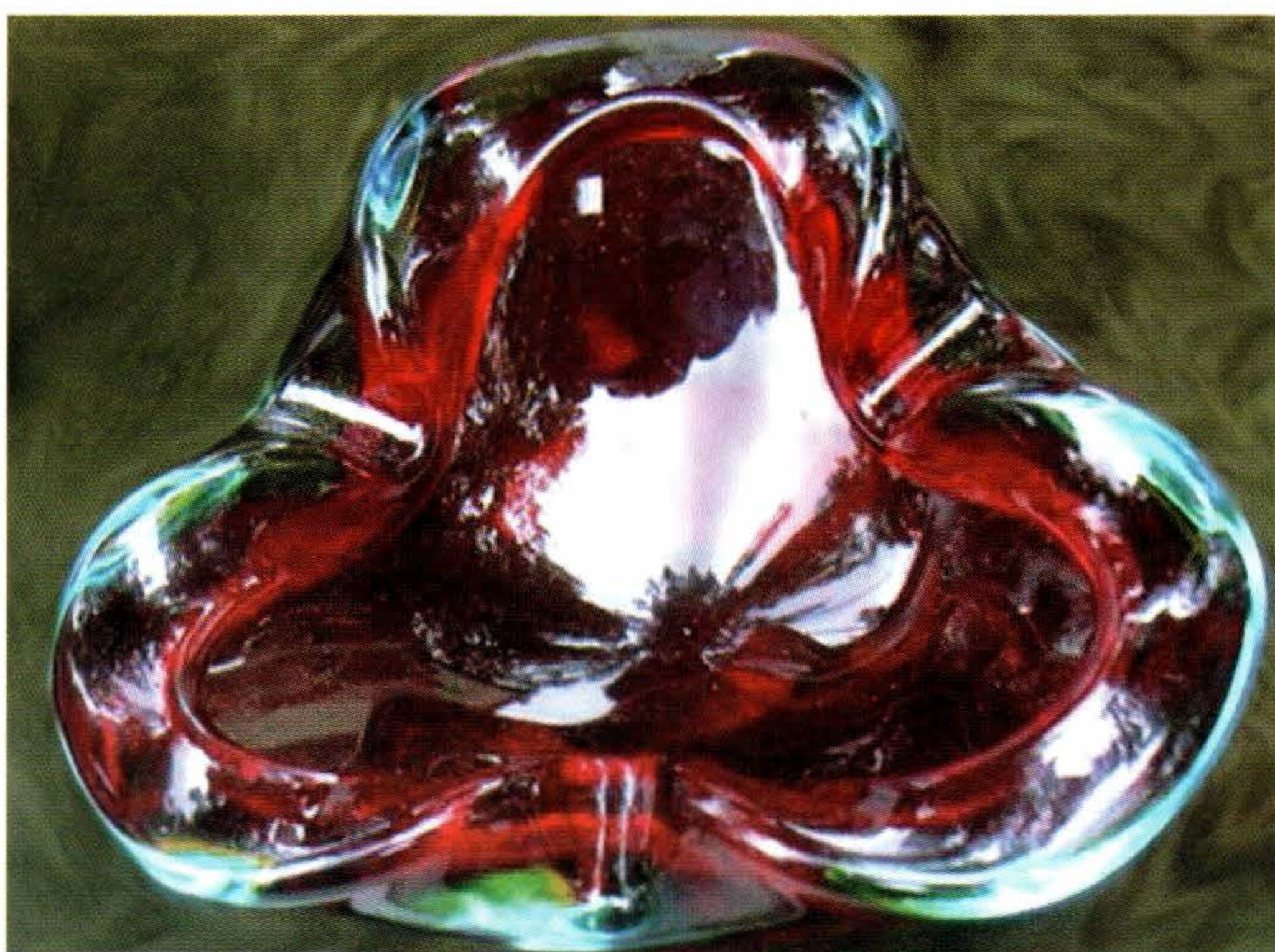
Fot. 12. Szkło „plazmonowe” – szkło z dodatkiem nanowytrąceń złota. Jest ono czerwone w świetle przechodzącym, a niebieskawe w wewnętrznych odbiciach. Źródłem niebieskiej barwy są plazmony, kolektywne wzbudzenia elektronów w nanowytrąceniach złota. Materiał ten, wynaleziony w Berlinie w XVII wieku, jest rodem z wieku XXI (zbiory autora)
