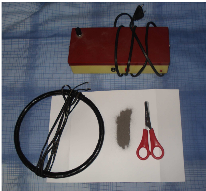
Rysunek 4.8 Materiały potrzebne do wykonania doświadczenia demonstracja pola elektromagnetycznego elektromagnesu.
