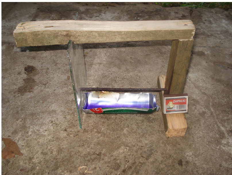
Rysunek 5.12 Gotowy układ pomiarowy do wykonania doświadczenia rozszerzalność termiczna ciał stałych.
