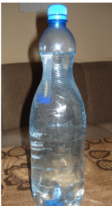
Rysunek 5.7 Gotowy do doświadczenia nurek Kartezjusza.
