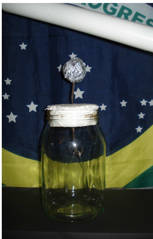
Rysunek 4.3 Przedstawienie wpływu naładowanego przedmiotu na elektroskop.
