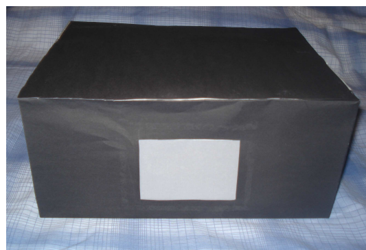
Rysunek 3.17 Gotowe doświadczenie camera obscura z widokiem na kalkę techniczną, na której obserwujemy obraz.
