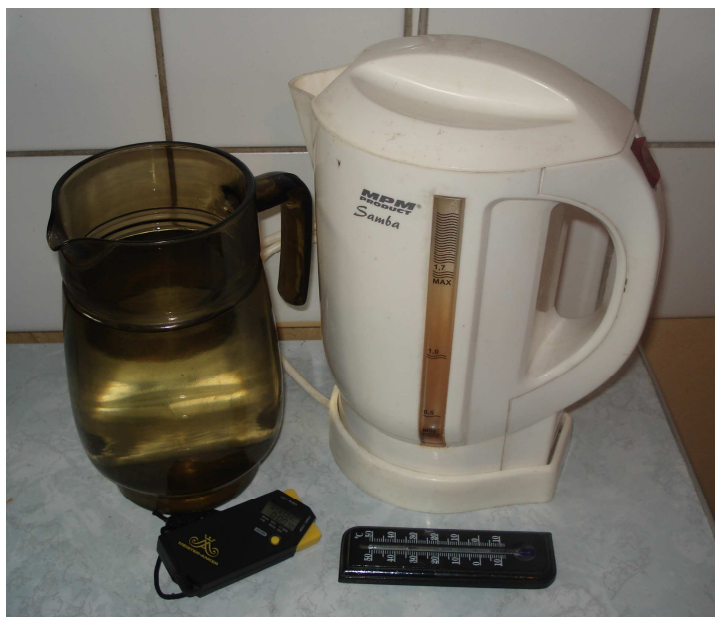
Rysunek 4.7 Materiały potrzebne do wykonania doświadczenia wyznaczenie mocy bezprzewodowego czajnika elektrycznego.
