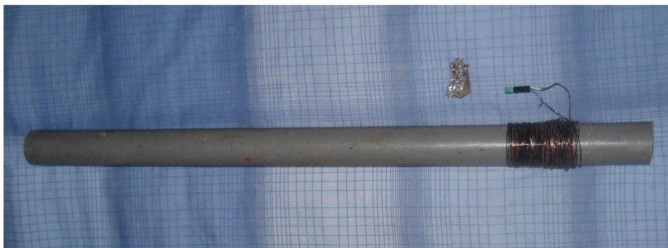
Rysunek 4.12 Gotowy zestaw do wykonania doświadczenia przedstawiającego wpływ zmiennego pola magnetycznego.
