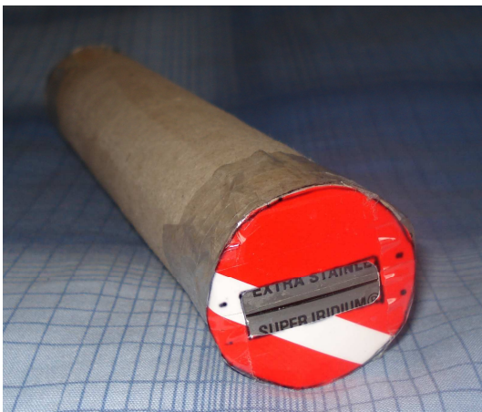
Rysunek 3.7 Gotowy spektroskop z widokiem na szczelinę wykonaną z żyłki.
