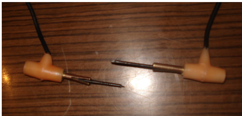
Rysunek 4.5 Połączenie grafitu z końcami przewodów z zasilacza w doświadczeniu demonstracja łuku elektrycznego.
