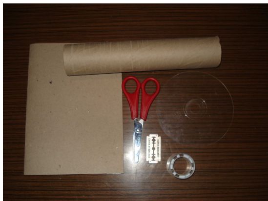
Rysunek 3.5 Materiały potrzebne do wykonania doświadczenia spektroskop przy użyciu krążka oddzielającego płyty CD.
