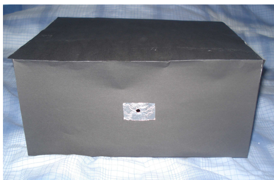
Rysunek 3.16 Gotowe doświadczenie camera obscura z widokiem na otwór, przez który wpada światło.
