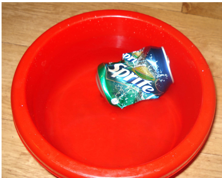
Rysunek 5.5 Końcowy efekt wykonania doświadczenia zjawisko implozji.
