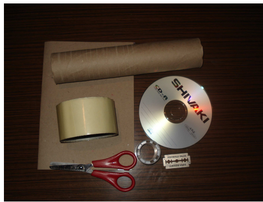
Rysunek 3.6 Materiały potrzebne do wykonania doświadczenia spektroskop przy użyciu płyty CD.
