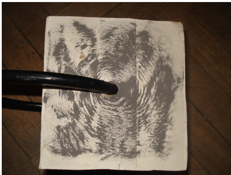
Rysunek 4.10 Linie sił pola elektromagnesu, przez który płynie prąd.
