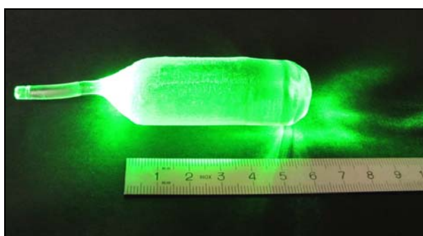
Rys.8.8. Kryształ toru z domieszką fluorku wapnia hodowany metodą Czochralskiego 15 .
