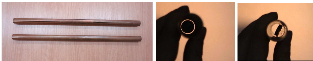
Ryc. 1. Dwie rurki miedziane i spadający w nich magnes - poglądowa realizacja całki krzywoliniowej w prawie indukcji elektromagnetycznej Faradaya. W rurce pełnej spadający magnes „lewituje”, wisząc w powietrzu i nie dotykając ścianek; w rurce naciętej podłużnie magnes spada „koziołkując” i obijając się o ścianki
