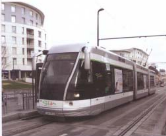
Fot. 5. Osobliwością Nancy jest pół-tramwaj, pół-trolejbus – pojazd poruszający się na gumowych kołach, zasilany prądem i używający dodatkowo jednej szyny. Nawet ten „tramwajo-lejbus” nazywa się Stan (fot. autor)
