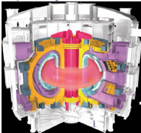
Ryc. 6.6. Schemat próbnego reaktora do kontrolowanej syntezy termojądrowej ITER we Francji; sercem urządzenia zwanego „tokamak” jest sznur plazmy o temperaturze 150 mln K utrzymywanej w komorze z próżnią za pomocą gigantycznych magnesów nadprzewodzących; dla porównania rozmiarów – sylwetka człowieka w prawym dolnym rogu; koszt instalacji 13 mld euro (Źródło: ITER)
