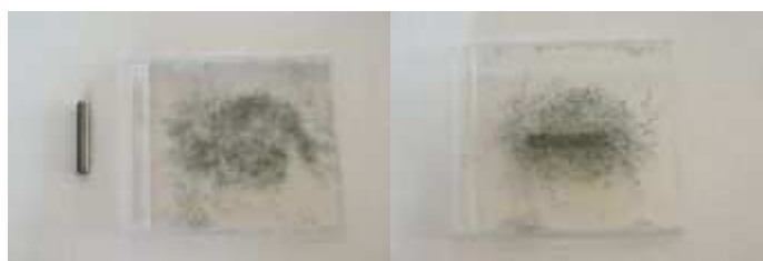
Zdjęcie 1. Magnes i opiłki. Badanie pola magnetycznego za pomocą opiłków.
