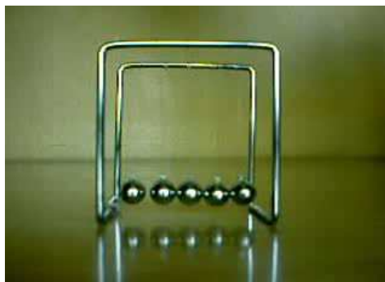
Fot. 31 Wahadło Newtona obrazujące zasadę zachowania pędu w podręczniku Mechanika (Smolarek)
