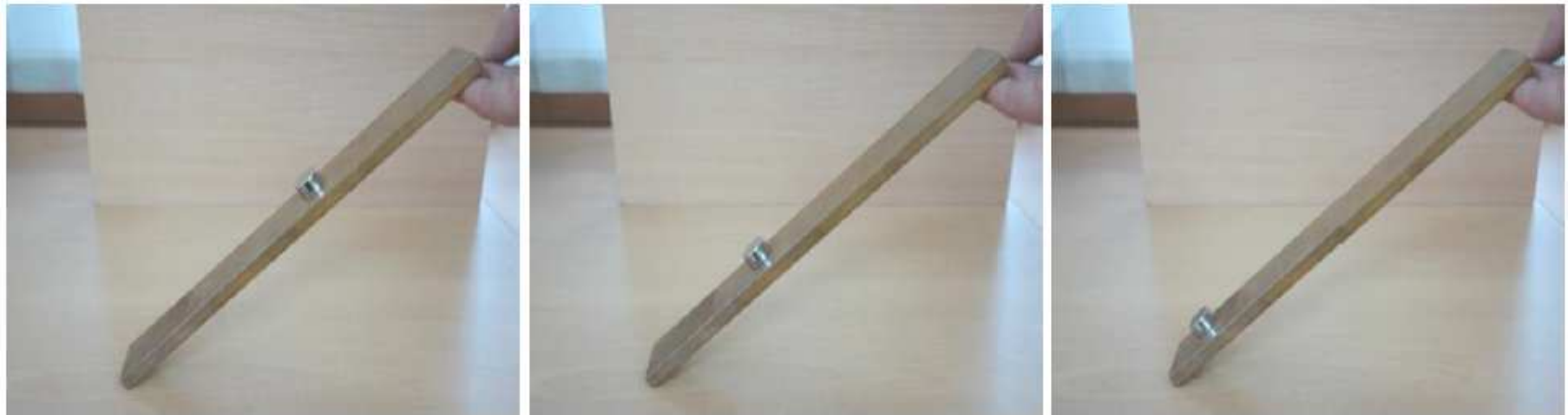
Fot. 3.5 Ruchem jednostajnym zsuwa się też neodymowy magnes po miedzianej płycie.
