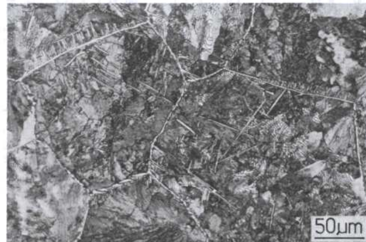
6.28. Mikrostruktury stali węglowych po powolnym chłodzeniu: a) ferryt i cementyt trzeciorzędowy (zaw. mniej niż 0,0218% C), b) struktura ferrytyczno-perlityczna (zaw. ok. 0,6% C), c) struktura perlityczna (zaw. ok. 0,77% C), d) struktura składająca się z perlitu i cementytu drugorzędowego (zaw. ok. 1,3% C)
