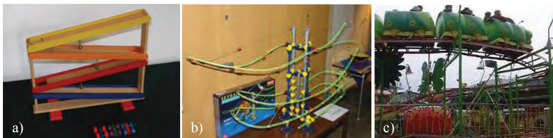
Fot. 4.6. Zjeżdżalnie – aspekty dydaktyczne i ludyczne: a) samochodziki o różnych masach zjeżdżają po równi z tą samą prędkością; b) skomplikowana zjeżdżalnia z kulkami – w górę i pod górę, ilustrująca zasadę zachowania energii; c) podobny eksponat w lunaparku (autor GK)
