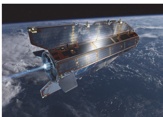
Fot. 6.11. a) Satelita do pomiarów grawitacji (GOCE) lata na niskiej orbicie (150 km) i używa silników jonowych na ksenon do korekty trajektorii lotu (Źródło: ESA)
