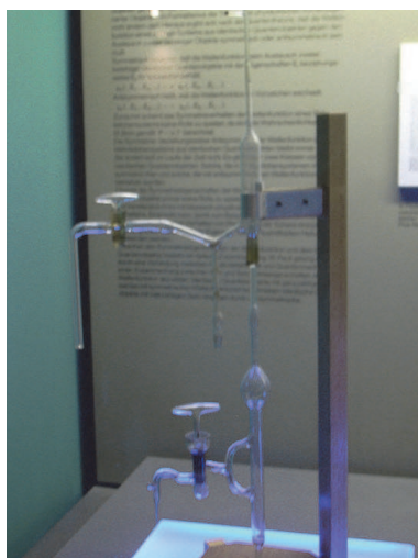
Fot. 3.5. Dwa epokowe doświadczenia z końca XIX wieku w Deutsches Museum w Monachium: a) E. Rutherforda, pokazujące że w rozpadzie polonu powstaje hel (kopia); b) J. J. Thompsona, odkrycie elektronu, odchyłanie promieni katodowych przez pole elektryczne i magnetyczne (oryginał)
