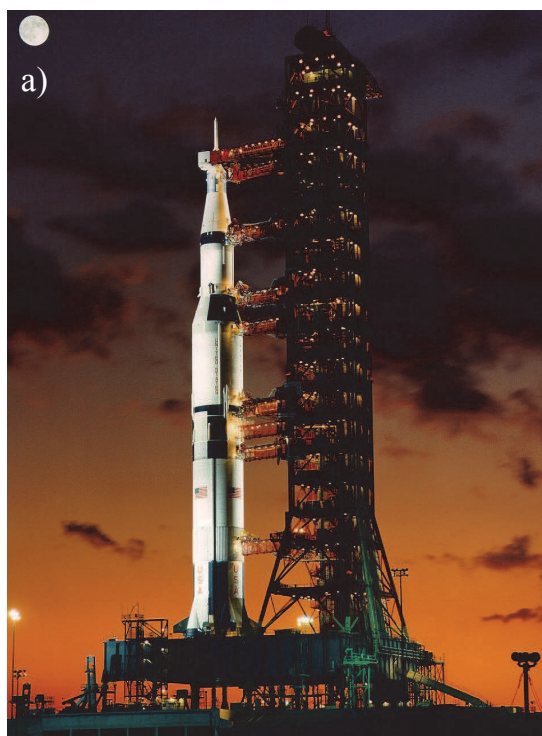
Fot. 1.15. II prędkość kosmiczna dla Ziemi wynosi 11,2 km/s natomiast dla Księżyca tylko 2,38 km/s. Wystartowanie w kosmos z Księżyca jest więc o wiele łatwiejsze niż z Ziemi; a) Rakieta Saturn startująca z Ziemi miała wysokość 110 m i masę na starcie 3 tys. ton; b) lądownik księżycowy miał wysokość niecałe 10 metrów (łącznie z łapami) i masę startową 4,7 tony 19 (Źródło: NASA)
