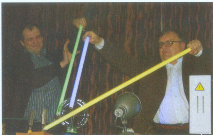
Fot. 4. Aby zapalić lampę jarzeniową, nie trzeba nawet dotykać kuli plazmowej – wystarczy do niej zbliżyć jeden koniec (drugi jest uziemiony ręką wykładowcy). Napięcie na zewnątrz kuli może przekraczać 1 kV.
