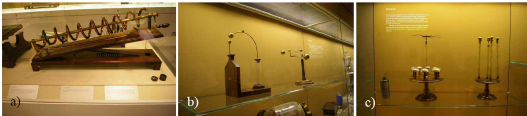
Fot. 6.19. Kolekcja historyczna przyrządów naukowych – zbiory króla Jerzego III: a) śruba Archimedesesa używana do przelewania wody do góry; b) butelka lejdejska, czyli pierwsza konstrukcja kondensatora elektrycznego; c) różnorodne doświadczenia z elektrostatyki (fot. ŁK)
