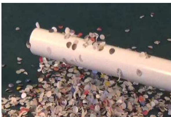
Fot. 10.2. Cekiny "przykleiły się" do naładowanej rurki.
