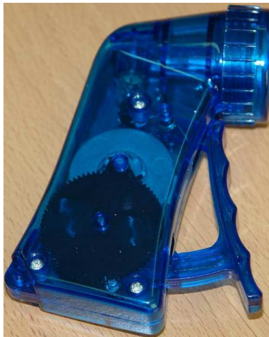
Fot. 8.1. Latarka "dynamo".
