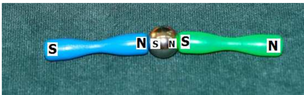
Fot 2.4. Pręciki magnetyczne zbliżone biegunami różnoimiennymi oraz indukowane pole magnetyczne w kulce
