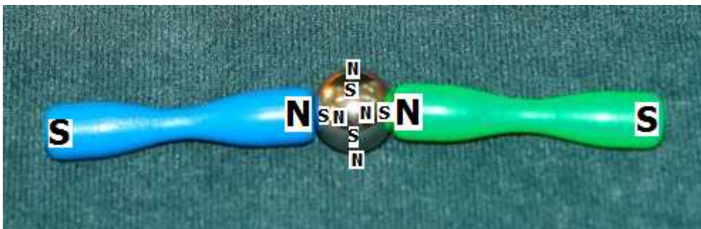
Fot 2.5. Pręciki magnetyczne zbliżone biegunami jednoimiennymi oraz indukowane pole magnetyczne w kulce.
