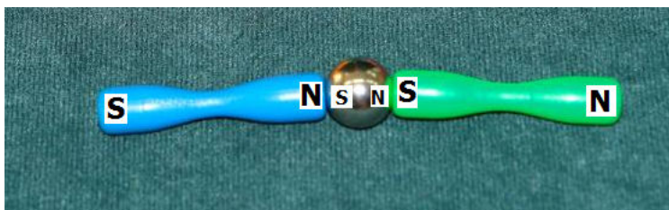
Rysunek 2. Pręciki magnetyczne zbliżone biegunami różnoimiennymi oraz indukowane pole magnetyczne w kulce.
